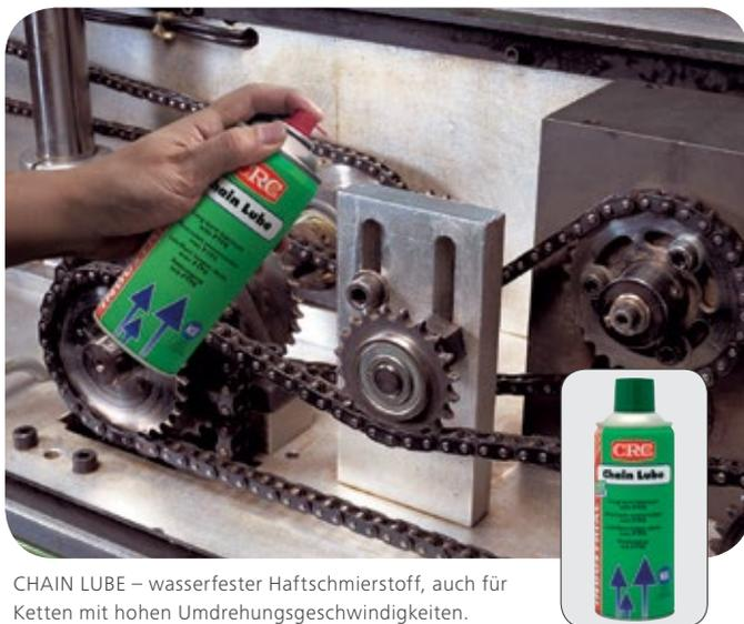
CHAIN LUBE – wasserfester Haftschrmerstoff, auch für Ketten mit hohen Umdrehungsgeschwindigkeiten.
