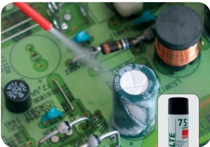
KÄLTE 75 SUPER ermöglicht die Fehlersuche sogar unter Spannung.
