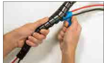
Helawrap wird nun nach dem Reißverschlussprinzip montiert.
