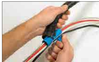
Helawrap auf das Werkzeug aufstecken.
