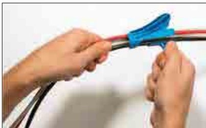
Kabelbündel seitlich in das Aufziehwerkzeug legen.
