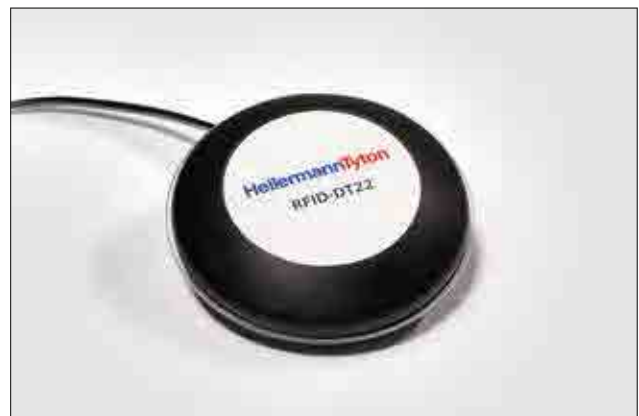
RFID-DT22 – Tischlesegerät für Hochfrequenztransponder (HF).
