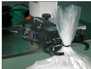
Anwendungsbeispiel: Verschließen von Beuteln in der horizontalen Montagevorrichtung.
