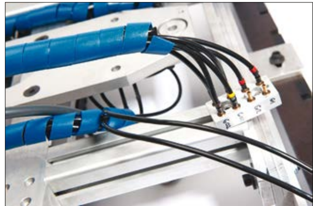
Detektierbare, metallhaltige Spiralschläuche schützen Kabel an Lebensmittelverarbeitungsmaschinen.
