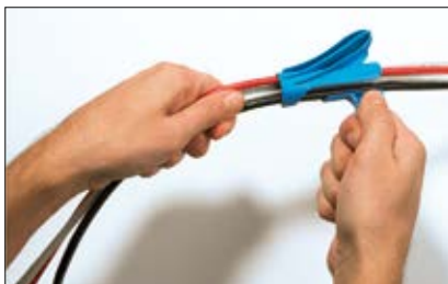
Kabelbündel seitlich in das Aufziehwerkzeug legen.
