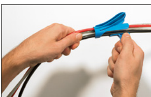
Kabelbündel seitlich in das Aufziehwerkzeug legen.
